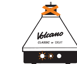
De complete balloneenheid verwijderen
