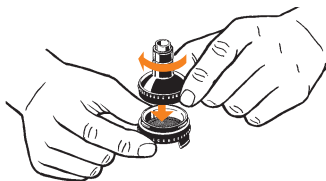
Deksel van de vulkamer vastschroeven
