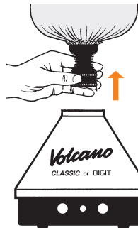
De complete balloneenheid verwijderen
